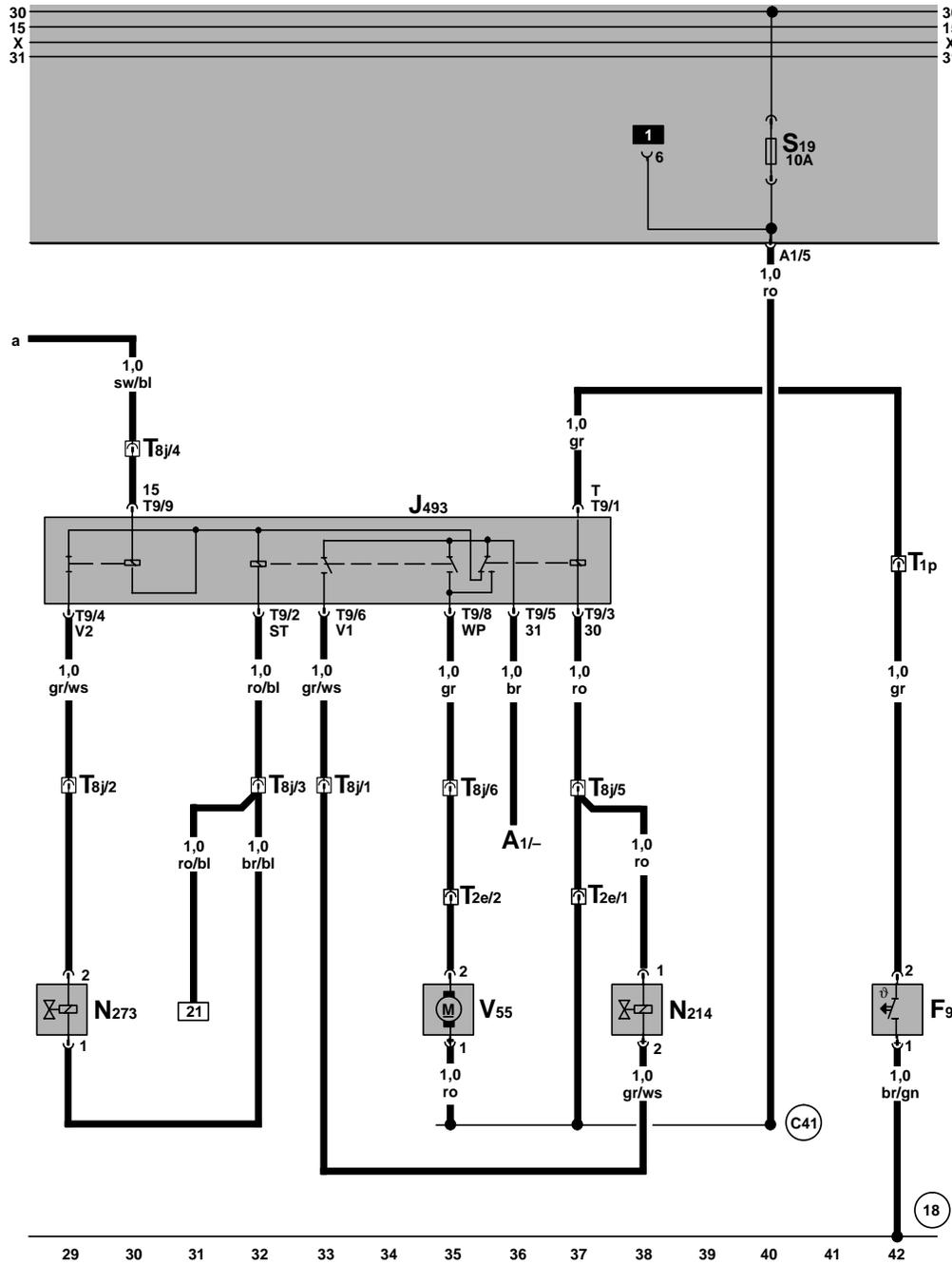
Relais für Zusatzwasserheizung, Zweiwegeventil für Kühlerabspernung, Umwälzpumpe, Zweiwegeventil für Kühlmittelkreislauf, Thermoschalter für Kühlmittelnachlauf
