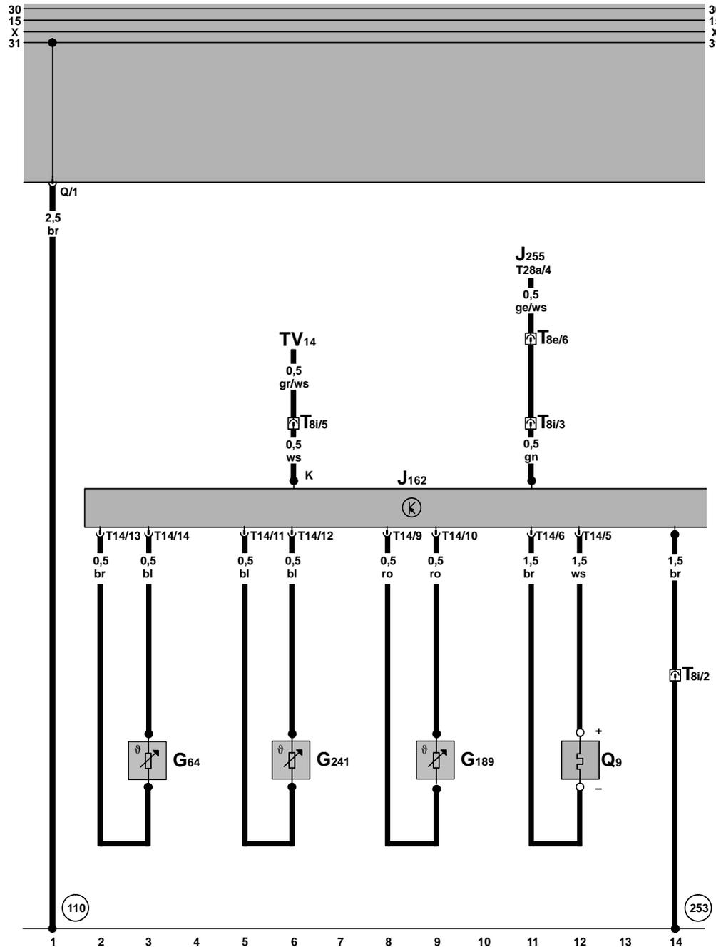
**Steuergerät für Heizung B4W/D4W, Flammenwächter, Überhitzungsfühler, Geber für Kühlmitteltemperatur, Glühkerze für Heizung**
